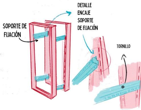
FIJAR LOS RIELES A LOS SOPORTES DE FIJACIÓN.
