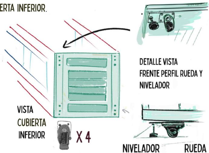
INSTALAR ACCESORIOS (PANEL DE VENTILACIÓN, PDU Y CUBIERTAS)
