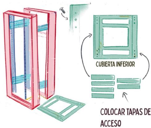
FIJAR RUEDAS Y NIVELADORES A LA CUBIERTA INFERIOR.
