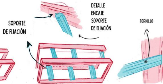
FIJAR LOS RIELES A LOS SOPORTES DE FIJACIÓN.
